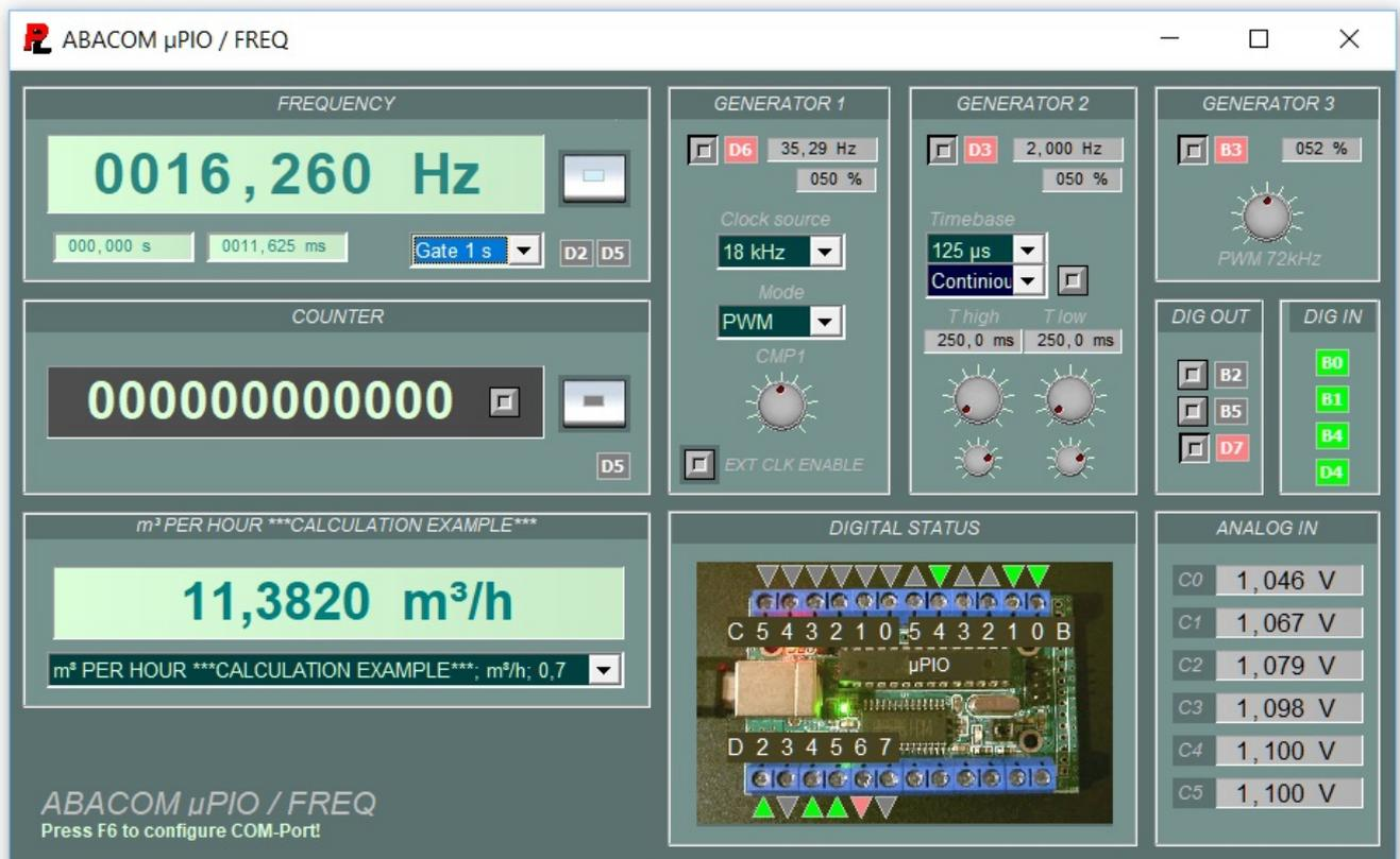
Eine kostenlose PC-Software steht zur Verfügung. Diese ermöglicht neben der Bedienung auch die einfache Datenabfrage per DDE aus anderen Programmen.
